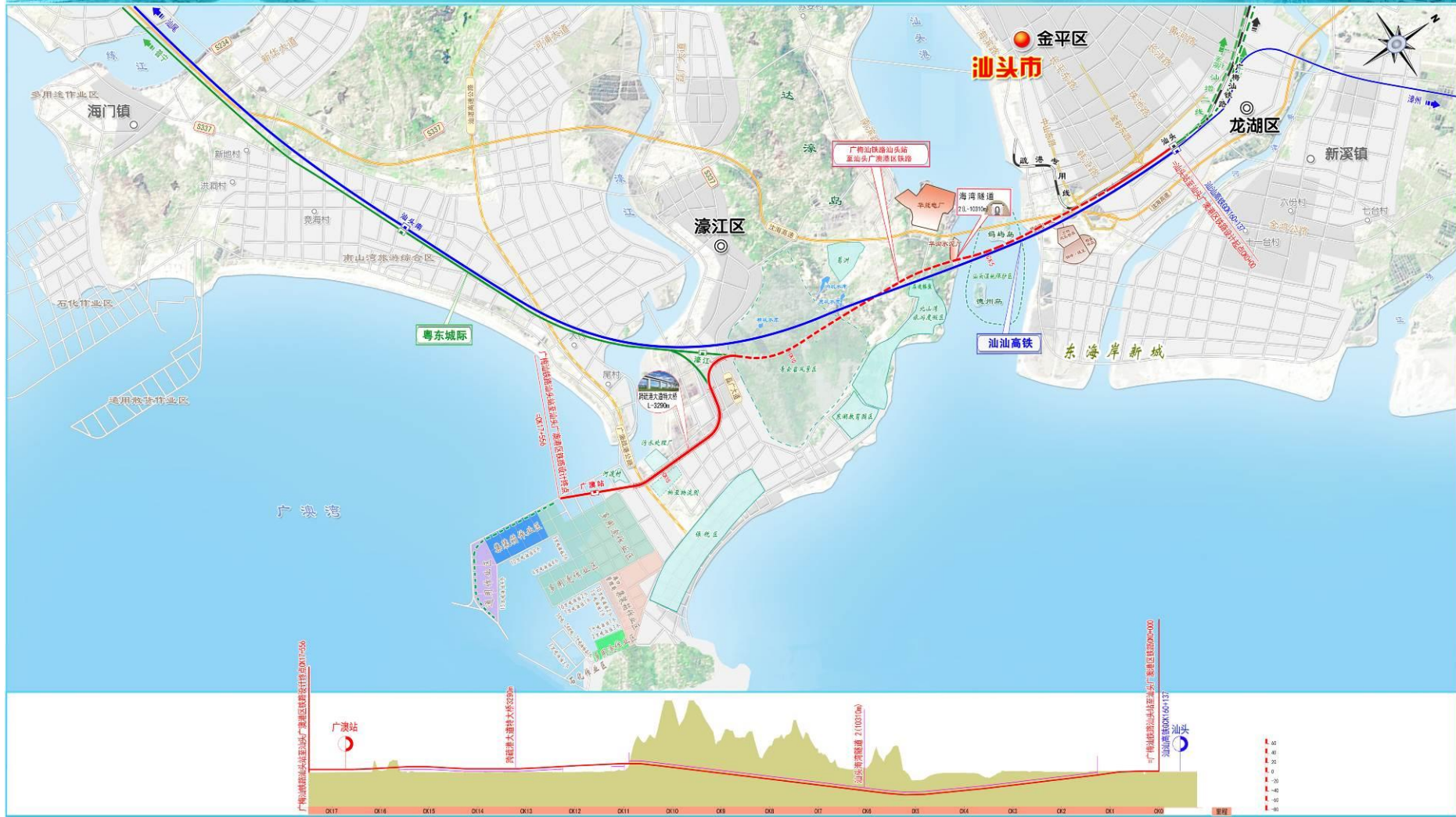
图1 广梅汕铁路汕头站至汕头广澳港区铁路可行性研究线路平纵断面示意图
